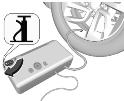
12. Iniziare immediatamente la guida, in modo da distribuire uniformemente il sigillante nel pneumatico. Dopo aver percorso circa 5 km ma non oltre 10 minuti, fermarsi e controllare la pressione del pneumatico. Ruotare il selettore del kit sul simbolo della pompa aria. Collegare il flessibile dell'aria del compressore alla valvola del pneumatico. Gonfiare lo pneumatico come indicato in precedenza. Scaricare la pressione pneumatici in eccesso tramite il pulsante presente sul kit.
