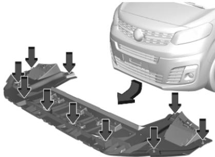
1. Svitare e rimuovere la copertura pavimento inferiore.
