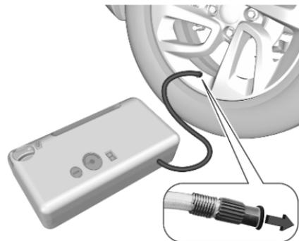
4. Svolgere completamente il flessibile dell'aria e svitare il tappo dall'estremità dello stesso. Collegare il flessibile alla valvola del pneumatico difettoso.
