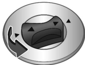
3. Ruotare i fermi in senso antiorario di un quarto di giro.
