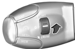
Ruotare su **Limit**, il simbolo
