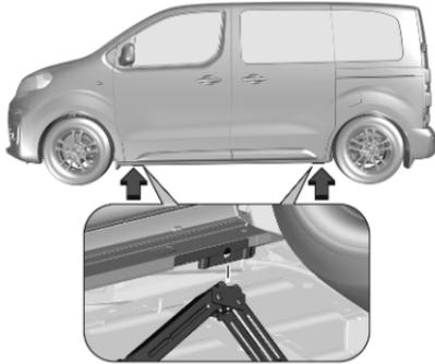
3. Controllare che il martinetto sia in posizione corretta sotto il relativo punto di sollevamento del veicolo. Posizionarlo direttamente sotto al punto di sollevamento, in modo da impedirne lo scivolamento.
