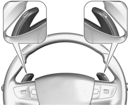
Su veicoli con cambio automatico, il cambio marcia può essere eseguito con il comando + o -.
