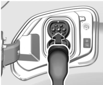
5. Inserire la presa del veicolo del cavo di carica nella presa di carica del veicolo.
