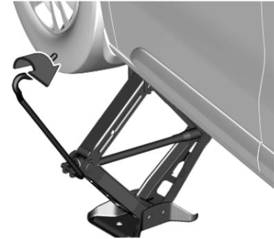
Con il martinetto correttamente allineato, ruotare la chiave fino a quando la ruota non poggia più per terra.
