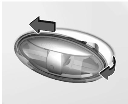
1. Far scorrere il portalampada in avanti e rimuoverlo sul retro. Potrebbe essere d'aiuto utilizzare un cacciavite per estrarre il portalampada dalla carrozzeria. Avvolgere la punta del cacciavite con un panno per evitare danni alla vernice.
