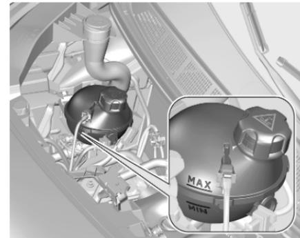
Quando il sistema di raffreddamento è freddo, il livello del liquido di raffreddamento dovrebbe essere al di sopra del segno **MIN**. Rabboccare se il livello è basso.
