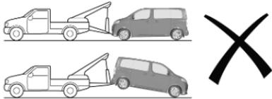
Quando si traina un veicolo elettrico o un veicolo dotato di cambio automatico, trasportarlo su una piattaforma o trainarlo con le ruote anteriori sollevate.
