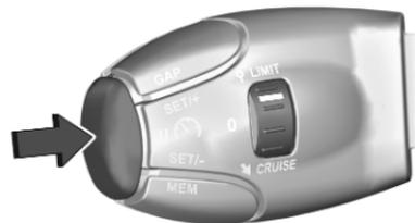
Premere il pulsante per disattivare la funzionalità. Il limitatore di velocità è in modalità pausa e viene visualizzato un messaggio. Nessun limite di velocità attivo.
