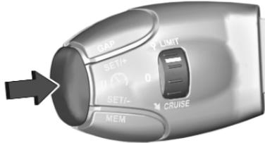
Premere il pulsante per disattivare la funzionalità. Il controllo automatico della velocità di crociera è in modalità pausa e viene visualizzato un messaggio. Si sta guidando il veicolo senza il controllo automatico della velocità di crociera.
