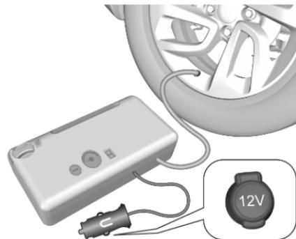
5. Collegare il cavo elettrico alla presa elettrica anteriore a 12 V del veicolo → 105.
