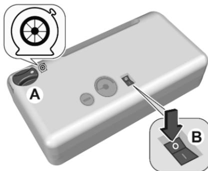
3. Ruotare il selettore **A** in posizione "sigillante". Controllare che l'interruttore **B** sia in posizione **O**.
