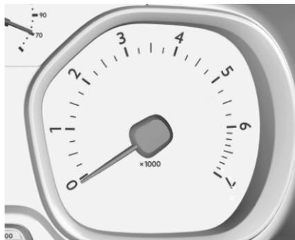
Indica la velocità di rotazione del motore.
