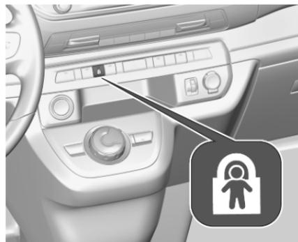
Sistema ad azionamento da remoto per impedire l'apertura delle portiere scorrevoli mediante le maniglie interne.
