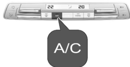
Premere **A/C** per inserire il raffreddamento. Il raffreddamento funziona solamente con il motore acceso e la ventola di controllo del climatizzatore inserita.
