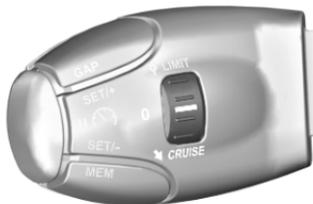
Ruotare su **0** per disattivare il sistema. Il simbolo
