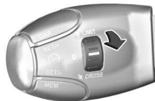
Ruotare su **Cruise**, il simbolo
