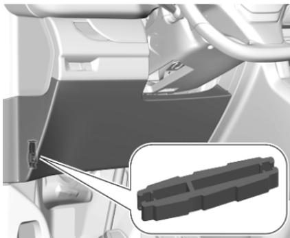
Sganciare la copertura sollevandola nella parte superiore di sinistra, poi di destra. Disinserire completamente la copertura e capovolgerla.
