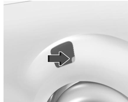
Se il veicolo è dotato del sistema chiave elettronica, lo sportellino di rifornimento carburante può essere aperto solo se il veicolo è sbloccato.
