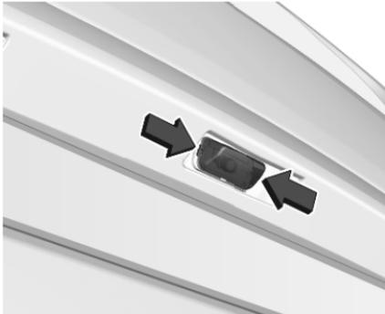
Inserire un cacciavite sottile, ad es. in una delle cavità della copertura e spingerlo verso l'esterno per sganciarlo. Rimuovere la copertura.
