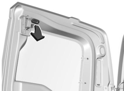
Avvolgere la punta di un cacciavite a taglio con un panno per evitare danni alla vernice. Rimuovere la copertura interna o la bocchetta dell'aria con il cacciavite.
