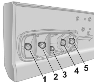
3. Spingere leggermente la lampadina nel portalampada, ruotarla in senso antiorario, rimuoverla e sostituirla.
