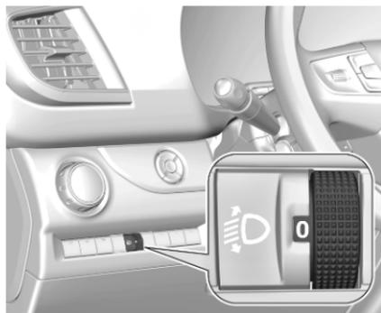
Per regolare la profondità delle luci in base al carico del veicolo e non abbagliare i conducenti dei veicoli in avvicinamento: ruotare l'interruttore rotante  $\equiv$ ● nella posizione desiderata.
