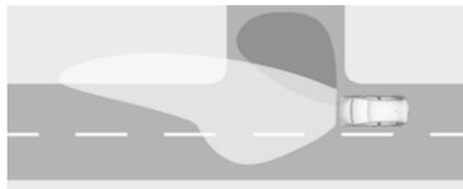
Si attiva fino a una velocità di 40 km/h durante le svolte. A seconda dell'angolo di sterzata o dell'attivazione degli indicatori di direzione, i fendinebbia anteriori illuminano la direzione di marcia.
