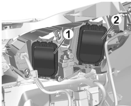
La lampadina dell'indicatore di direzione si trova nell'alloggiamento di destra (1)
