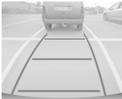
L'area dietro al veicolo viene mostrata sullo schermo. Le linee verticali corrispondono alla larghezza del veicolo con gli specchietti aperti. La direzione delle linee cambia a seconda della posizione del volante.
