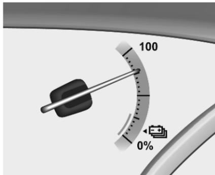
L'indicatore della batteria ad alta tensione mostra il livello di carica della batteria ad alta tensione.
