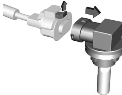
3. Disinserire il connettore a spina tirando sulla linguetta di fermo.
