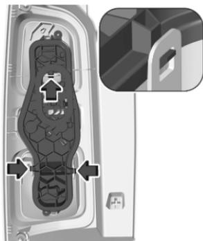
7. Disinnestare la linguetta di fissaggio, tirare il portalampada e sganciare le altre linguette di fissaggio.
