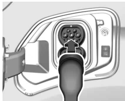
5. Inserire la presa del veicolo del cavo di carica di modalità 3 nella presa di carica del veicolo.
