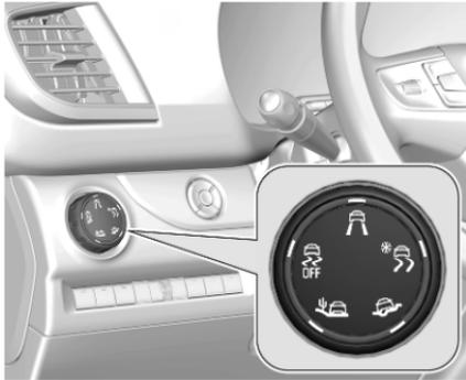
Il sistema di controllo selettivo della guida permette di scegliere tra cinque modalità di guida ruotando il comando:
