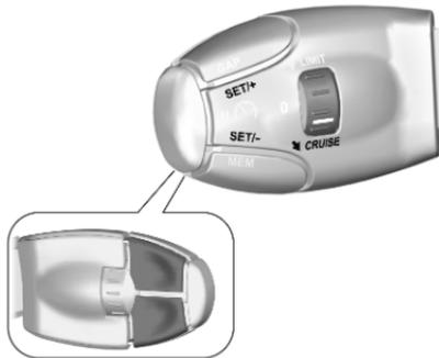
Accelerare fino alla velocità desiderata e premere **SET/+** o **SET/-**. La velocità corrente viene memorizzata e mantenuta. Il pedale dell'acceleratore può essere rilasciato.
