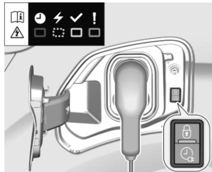
L'inizio della ricarica viene indicato dalla luce verde lampeggiante dell'indicatore di stato della presa di carica e nella scatola di comando del cavo di carica.
