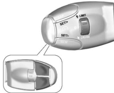
La velocità preimpostata si può impostare premendo **SET/+** per aumentarla oppure **SET/-** per diminuirla. Premere brevemente per cambiare la velocità preimpostata a piccoli intervalli, premere più a lungo per intervalli più grandi. La velocità viene indicata nel Driver Information Center.
