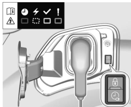
L'inizio della ricarica viene indicato dalla luce verde lampeggiante dell'indicatore di stato sulla presa di carica.
