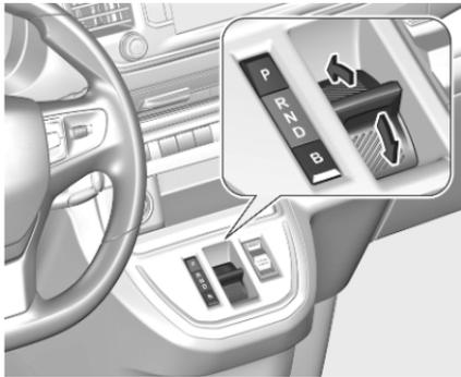
Se la leva del cambio è in **B**, l'energia viene rigenerata quando si solleva il pedale dell'acceleratore. Inoltre, viene messa in atto la decelerazione del veicolo.
