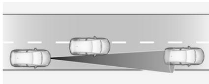
Se un altro veicolo entra nel percorso di guida, il cruise control semi-adattivo considererà il veicolo solamente quando sarà totalmente sullo stesso percorso. È necessario essere pronti ad agire e premere il pedale del freno se è necessario frenare più velocemente.
