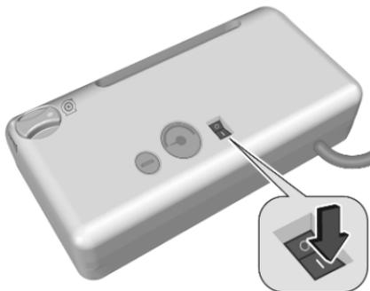
6. Impostare l'interruttore basculante presente sul compressore su I. Il pneumatico viene riempito di sigillante.
