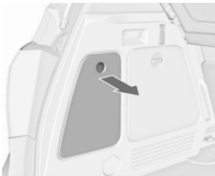
La scatola portafusibili si trova sul lato sinistro del vano di carico, dietro ad una copertura. Rimuovere la copertura.
