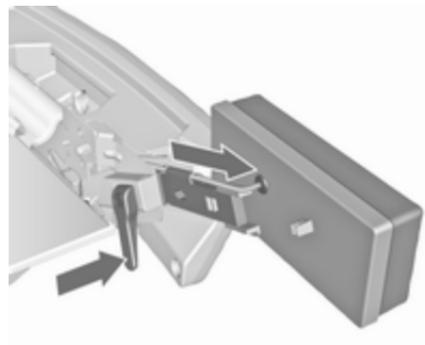
Spingere la leva di fissaggio verso il basso ed estrarre i supporti delle luci dalle cavità.
