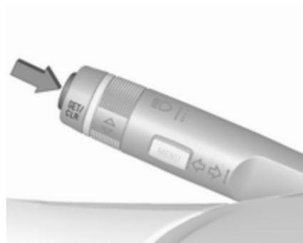
Azzerare il contachilometri parziale premendo **SET/CLR** sulla leva degli indicatori di direzione per alcuni secondi o, su veicoli con manopola di azzeramento, premendo la manopola accanto al tachimetro separatamente per la pagina 1 o 2.
