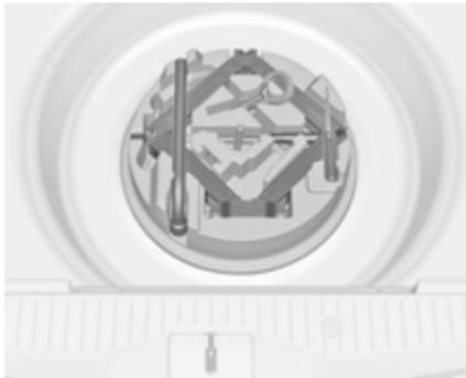
Il martinetto e gli altri attrezzi della vettura sono alloggiati nello spazio riservato alla ruota di scorta che si trova nel vano di carico.
