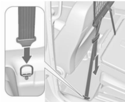
Appendere i ganci delle cinghie di tensionamento della rete negli occhielli di ancoraggio del pavimento, dietro ai sedili anteriori. Tendere la rete tirando la parte libera della cinghia.
