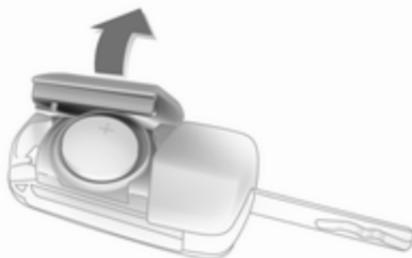
Estendere la chiave e aprire l'unità. Sostituire la batteria (di tipo CR 2032) prestando attenzione alla posizione di montaggio. Chiudere l'unità e sincronizzarla.
