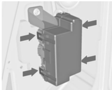
Sbloccare le quattro linguette di fissaggio e rimuovere la copertura.
