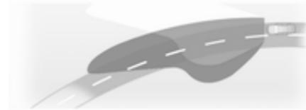
Il fascio di luce ruota a seconda dell'angolo di sterzata del volante e della velocità, migliorando la luminosità in curva.
