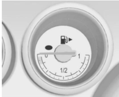
Visualizza il livello nel serbatoio carburante o del gas in base alla modalità di funzionamento.
