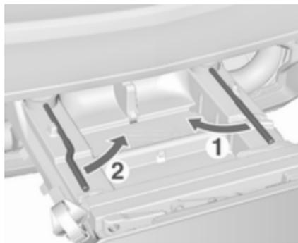
Ruotare prima la leva di bloccaggio destra (1), quindi la leva di bloccaggio sinistra (2), finché non si avverte una certa resistenza.
