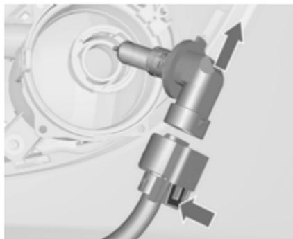
2. Sganciare il portalamпада del connettore premendo sulla linguetta di fissaggio.
