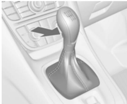
Per inserire la retromarcia, premere il pedale della frizione e il pulsante sulla leva del cambio e inserire la marcia.
