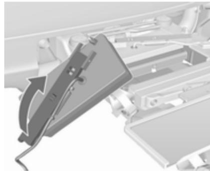
Aprire completamente il portalam-pada sulla parte posteriore della luce posteriore.
