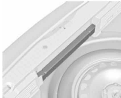
Riporre il triangolo di emergenza nello spazio che si trova nella parte posteriore del vano di carico.
