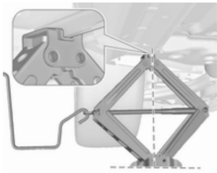
Regolare il martinetto all'altezza necessaria. Posizionarlo direttamente sotto il punto di sollevamento del veicolo in modo che non scivoli.
