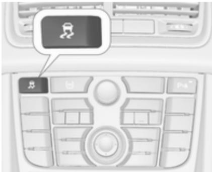
Il sistema di controllo della trazione può essere disattivato quando è richiesto lo slittamento delle ruote motrici: premere brevemente
