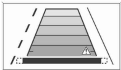
A causa dell'altezza elevata della videocamera, il display visualizza il paraurti posteriore come guida per il posizionamento.
