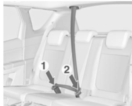
Inserire a pressione la piastrina di chiusura inferiore nella fibbia destra (1) del sedile centrale. Rimuovere la piastrina di chiusura superiore dal fermo, portare la cintura sulla spalla e sull'addome (senza torcerla) e inserirla nella fibbia sinistra (2) del sedile centrale.
