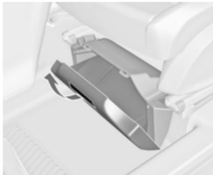
A seconda della vettura, sotto al sedile del conducente è posizionata una scatola. Tirare la maniglia e ripiegare la copertura. Carico massimo: 1,5 kg.
