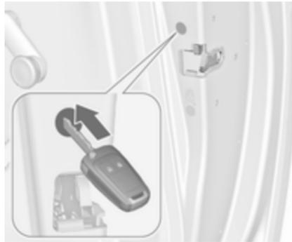
Inserire la chiave nell'apertura sopra alla serratura che si trova all'interno della portiera e premere fino a quando non si sente uno scatto. Poi chiudere la portiera. La procedura deve essere eseguita per ciascuna porta. È possibile bloccare la portiera del conducente anche dall'esterno con la chiave. Lo sportellino del carburante e il portellone posteriore non possono essere bloccati.
