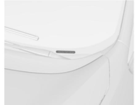
Il numero di telaio potrebbe essere stampato in rilievo sul cruscotto visibile attraverso il parabrezza, o nel vano motore sul pannello carrozzeria di destra.
