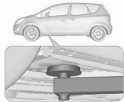
Posizione del braccio anteriore della piattaforma nel sottoscocca.
