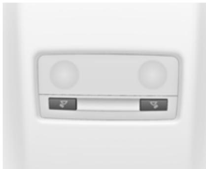
Si accendono insieme alla luce di cortesia anteriore a seconda della posizione dell'interruttore basculante.
