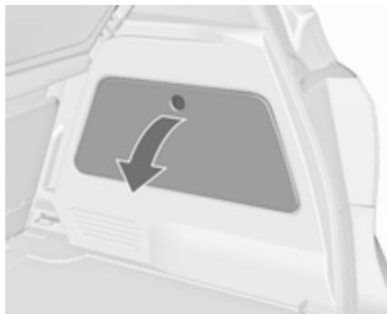
Per aprire il vano, sbloccare il coperchio e aprirlo, o, in base alla versione, sollevare la copertura del pianale.
