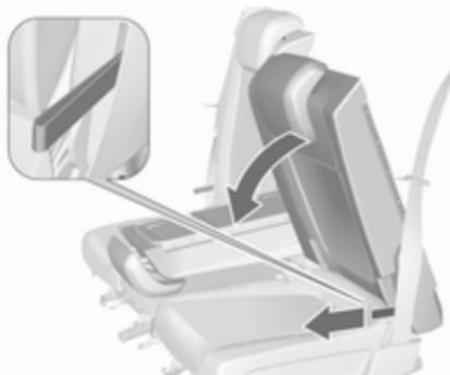
Tirare la cinghia sul lato anteriore dello schienale e reclinare lo schienale sulla seduta. Il sedile si abbassa automaticamente se il sedile centrale è ribaltato.
