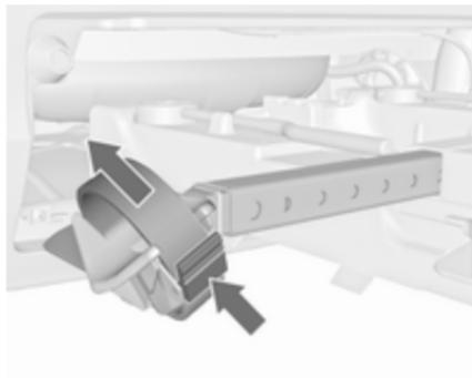
Premere la leva di sblocco sul fermo e rimuoverlo.
