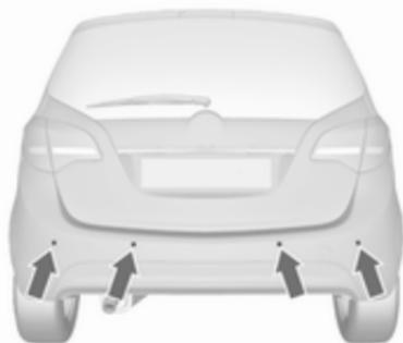
Il sistema è costituito da quattro sensori di parcheggio ad ultrasuoni ubicati nei paraurti posteriori. Se il veicolo è dotato di un sistema di ausilio al parcheggio anteriore, altri quattro sensori a ultrasuoni sono posizionati nei paraurti anteriori.
