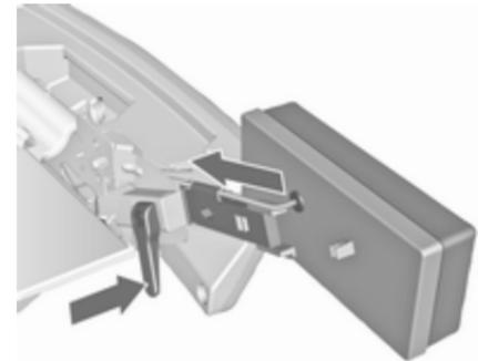
Premere la leva di bloccaggio verso il basso e premere il supporto della lampada nel fermo fino a quando si blocca.
