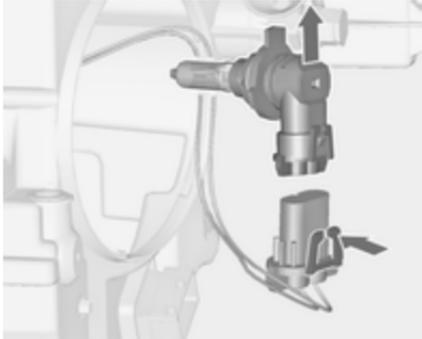
3. Sganciare il portalamпада del connettore premendo sulla linguetta di fissaggio.
