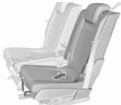
Tirare la maniglia e far scivolare il sedile in senso trasversale all'indietro fino alla posizione **1**. Il sedile viene guidato automaticamente all'interno. Rilasciare la maniglia e consentire al sedile di tornare in posizione.
