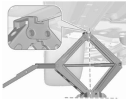
Regolare il martinetto all'altezza necessaria. Posizionarlo direttamente sotto il punto di sollevamento del veicolo in modo che non scivoli.
