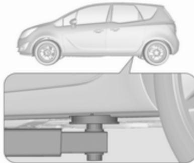
Posizione del braccio posteriore della piattaforma nel sottoscocca.
