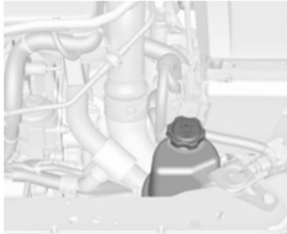
Il livello del liquido del servosterzo di norma non deve essere controllato. Se durante la sterzata si ode un rumore anomalo o il servosterzo reagisce in modo energetico, rivolgersi ad un'officina.
