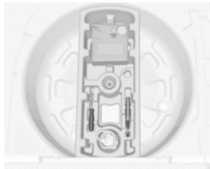
Variante 2: Gli attrezzi per il veicolo si trovano nel vano sotto la copertura del pianale nel vano di carico assieme al kit di riparazione dei pneumatici.
