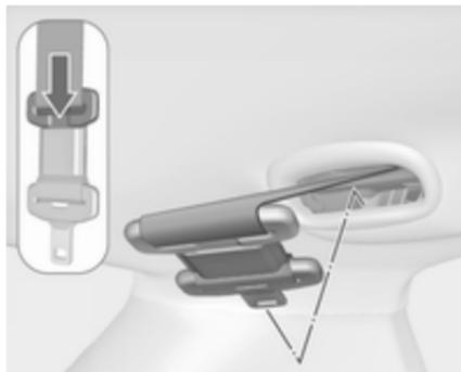
Premere la piastra di chiusura superiore nel fermo. Ripiegare le piastre di chiusura sulla cintura di sicurezza.
