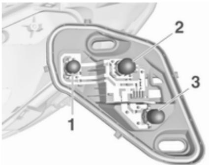
6. Rimuovere e sostituire la lampadina.
