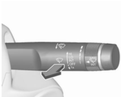
Tirare la leva. Il liquido di lavaggio viene spruzzato sul parabrezza e il tergicristalli effettua alcuni passaggi.
