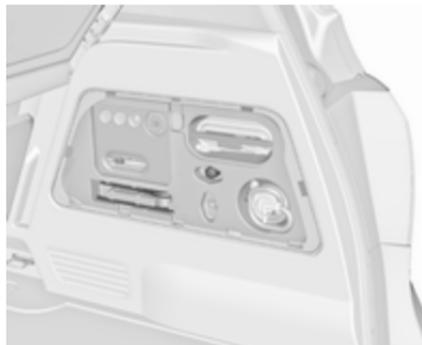
Variante 1: Gli attrezzi per il veicolo si trovano nel vano a destra del vano di carico assieme al kit di riparazione dei pneumatici.
