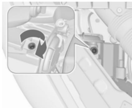
Con un cacciavite, ruotare le viti di regolazione in senso orario di mezzo giro.
