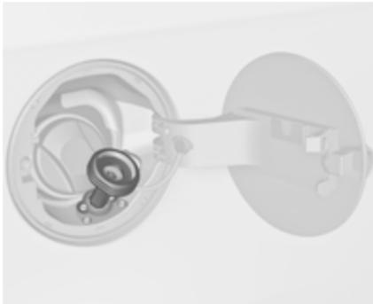
**Adattatore ACME:** Avvitare il dato dell'ugello di riempimento sull'adattatore. Premere verso il basso la leva di bloccaggio sull'ugello di riempimento.
