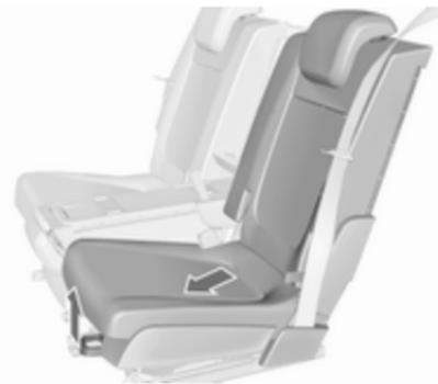
Tirare la maniglia e far scivolare il sedile in senso trasversale in avanti fino alla posizione **2**. Il sedile viene guidato automaticamente all'esterno. Rilasciare la maniglia e consentire al sedile di tornare in posizione.
