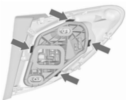
5. Sbloccare le quattro linguette di fissaggio e rimuovere il portalam-pada.
