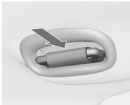
Inserire il supporto della cintura di sicurezza nel tetto con la piastra di chiusura inferiore girata in avanti.
