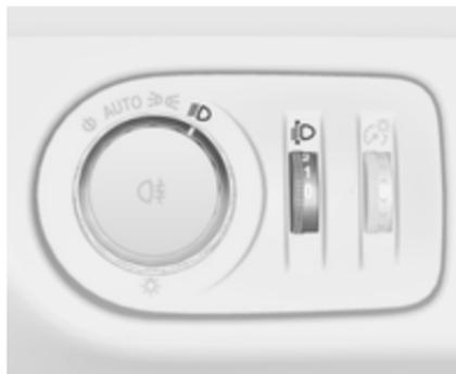
Per regolare la profondità delle luci in base al carico del veicolo e non abbagliare i conducenti dei veicoli in avvicinamento: ruotare l'interruttore rotante
