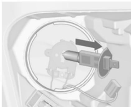
4. Rimuovere e sostituire la lampadina.
