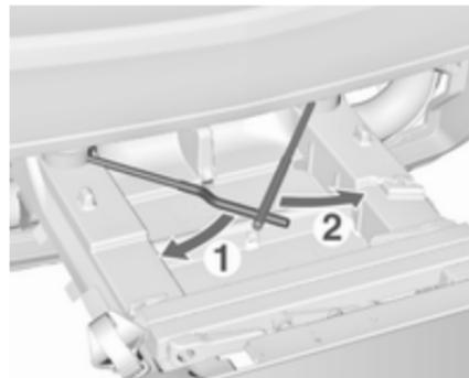
Ruotare prima la leva di bloccaggio sinistra (1), quindi la leva di bloccaggio destra (2), fino a battuta.
