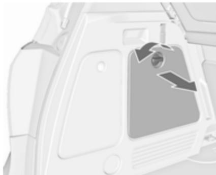
Ruotare il fissaggio in senso antiorario e ripiegare la copertura.
