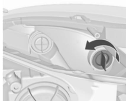
1. Ruotare il portalam-pada in senso antiorario e rimuoverlo.
