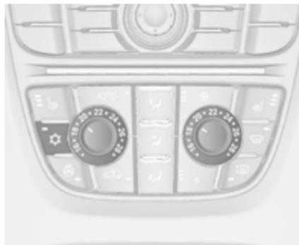
Premere ☼ per inserire il raffreddamento. L'attivazione è indicata dal LED sul pulsante. Il raffreddamento funziona solamente con il motore acceso e la ventola di controllo del climatizzatore inserita.
