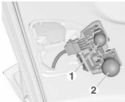
3. Per sostituire la luce della retromarcia (1), rimuovere la lampadina e sostituirla.
