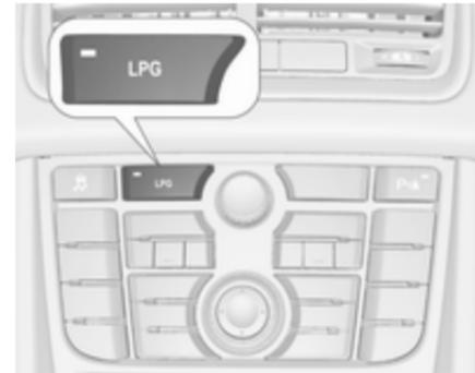
Premendo **LPG** si passa tra il funzionamento a benzina e quello a gas liquido. Lo stato del LED
