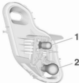
Si possono sostituire solo la luce del freno (1) e l'indicatore di direzione (2).
