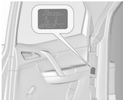
La targhetta di identificazione si trova nel telaio della portiera posteriore o anteriore destra.
