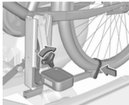
Serrare manualmente la vite di fissaggio del supporto del cuscinetto del pedale fino al punto massimo.
