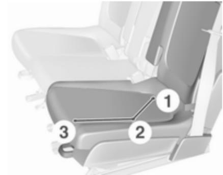
È possibile configurare la fila posteriore di sedili in modo che comprenda due sedili e il massimo spazio di seduta nella posizione **1**, oppure con tre sedili nella posizione **2**. Nella posizione **1**, il sedile centrale viene abbassato.
