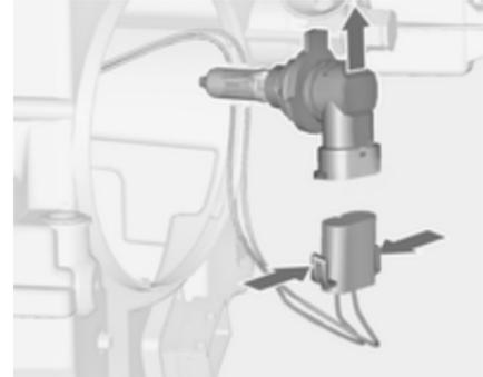
3. Sganciare il portalamпада del connettore premendo sulle linguette di fissaggio.
