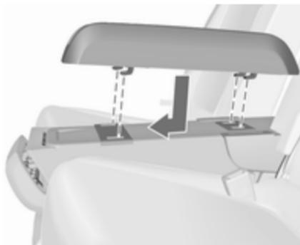
Inserire i ganci dell'adattatore negli incavi dello schienale del sedile e spingere l'adattatore in avanti.
