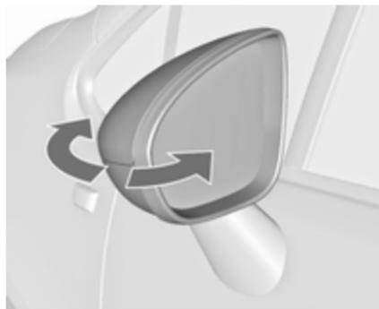
Per la sicurezza dei pedoni, i retrovisori esterni fuoriescono dalla normale posizione di montaggio se vengono colpiti con forza sufficiente. Per riposizionare lo specchietto è sufficiente esercitare una leggera pressione sul corpo dello stesso.
