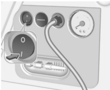
8. Premere l'interruttore di accensione/spegnimento sul compressore. Il pneumatico viene riempito di sigillante.
