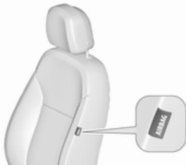
Il sistema airbag laterale è composto da un airbag nello schienale di ciascun sedile anteriore. La loro presenza viene segnalata dalla scritta **AIRBAG**.
