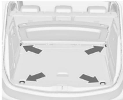
Gli occhielli di ancoraggio servono per fissare gli oggetti ed evitare che scivolino, utilizzando ad esempio delle cinghie di ancoraggio o una rete fermabagagli.
