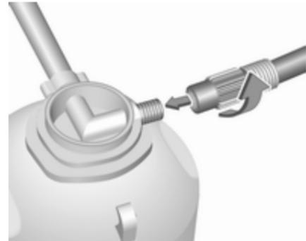
2. Staccare il tubo dell'aria dalla staffa e avvitarlo al raccordo della bombola.
