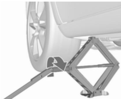
Fissare la chiave delle ruote e, con il martinetto correttamente allineato, ruotare la chiave fino a sollevare la ruota dal terreno.
