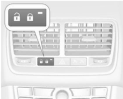
Il LED di stato è integrato nel pulsante di bloccaggio centrale.
