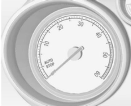
Indica la velocità di rotazione del motore.
