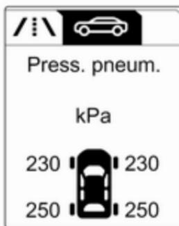
Ruotare la manopola di regolazione per selezionare il sistema di monitoraggio pressione pneumatici.
