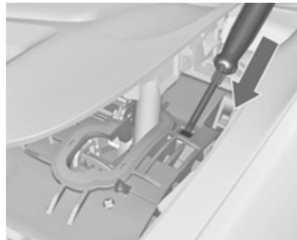
5. Inserire un cacciavite nell'apertura per quanto possibile e muovere la leva del cambio per uscire da **P** o **N**. Se **P** o **N** vengono di nuovo inserite, la leva del cambio si bloccherà di nuovo in posizione.
