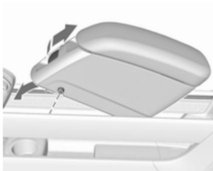
Abbassare il bracciolo nella parte anteriore. Tirare con decisione la maniglia anteriore e inserire i perni della guida anteriore nelle guide superiori. Rilasciare la maniglia. Muovere il bracciolo fino a quando si sente lo scatto del blocco in posizione.
