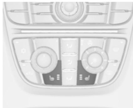
Regolare il riscaldamento sul livello desiderato premendo
