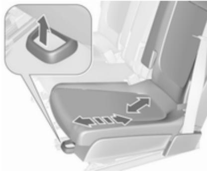
I sedili posteriori esterni possono essere spostati singolarmente avanti o indietro. È possibile spostare i sedili in senso longitudinale e trasversale.
