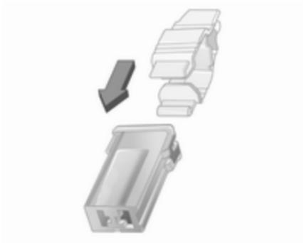
Posizionare l'estrattore per fusibili sulla sommità o sul lato del fusibile, a seconda del tipo, ed estrarre il fusibile.
