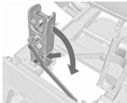
Sbloccare la leva di blocco sul supporto diagonale e piegare verso il basso le cavità della pedivella.
