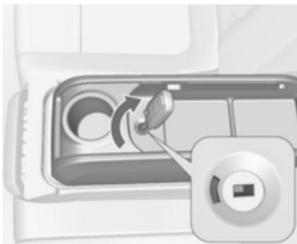
Bloccare l'adattatore ruotando la chiave di accensione in senso orario nel blocchetto. L'adattatore è bloccato correttamente quando è visibile il segno verde.
