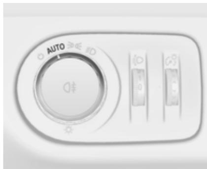
Quando la funzione di controllo automatico dei fari è attivata e il motore è acceso, il sistema alterna le luci di marcia diurna e gli anabbaglianti a seconda delle condizioni di luminosità.
