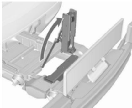
Piegare una o entrambe le cavità per i pedali verso l'alto fino a quando il supporto diagonale si blocca.
