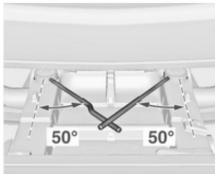
Il sistema di trasporto posteriore è bloccato quando le leve di bloccaggio sono girate di circa 50°. In caso contrario, la sicurezza del sistema non è garantita.
