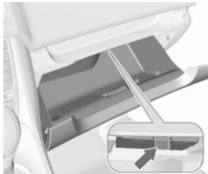
Il cassetto portaoggetti è dotato di un portapenne, di un portamonete e di un adattatore chiave per i bulloni di bloccaggio delle ruote.
