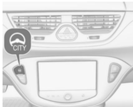
Premere il pulsante
