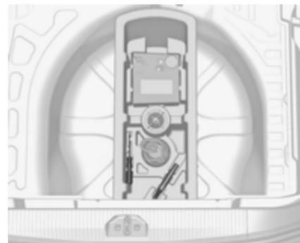
Su versioni con sistema di trasporto posteriore o pavimento con doppio fondo, gli attrezzi sono posizionati insieme al gancio di traino e al kit di riparazione pneumatici sul lato destro del vano di carico dietro ad un coperchio.
