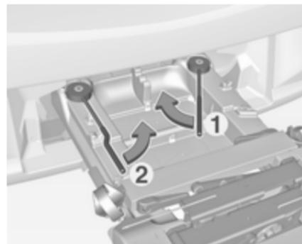
Ruotare in avanti prima la leva di fissaggio destra (1), poi la leva di fissaggio sinistra (2), fino a quando non si innestano nelle rispettive cavità.
