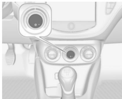
Premere il pulsante ☀ per inserire il raffreddamento. L'attivazione è indicata dall'illuminazione del LED sul pulsante. Il raffreddamento funziona solamente con il motore acceso e la ventola di controllo del climatizzatore inserita.
