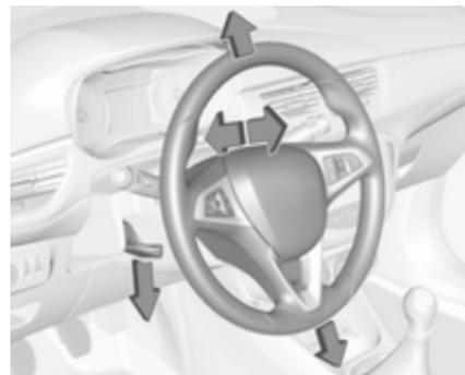
Sbloccare la leva, regolare la posizione del volante, quindi riportare la leva in posizione iniziale e accertarsi che sia completamente bloccata.
