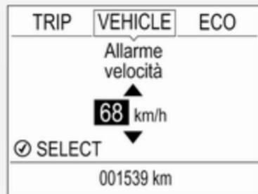
La funzione di segnalazione di velocità elevata emette un allarme quando si supera la velocità impostata.
