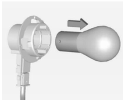
4. Smontare la lampadina spingendola leggermente nel portalamпада e ruotandola in senso antiorario. Sostituire la lampadina.
