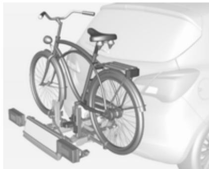
Il sistema di trasporto posteriore (sistema Flex Fix) consente di montare le biciclette su un sistema a estrazione integrato nel pianale del veicolo. Non è permesso trasportare altri oggetti.
