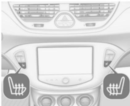
Attivare il riscaldamento del sedile premendo il pulsante
