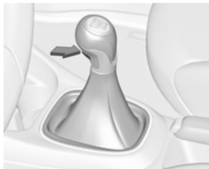
**Retromarcia:** con il veicolo fermo, premere il pedale della frizione e il pulsante di sblocco sulla leva del cambio, quindi innestare la marcia.
