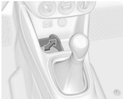
Il vano portaoggetti davanti alla leva del cambio è dotato di cinturino di gomma regolabile. Estrarre il cinturino per fissare un bicchiere o un posacenere.
