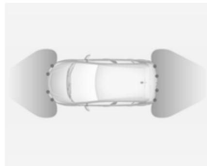
Il sistema è dotato di quattro sensori di parcheggio ad ultrasuoni ubicati nei paraurti posteriore e anteriore.
