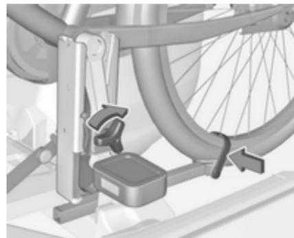
Serrare manualmente la vite del fissaggio del cuscinetto del pedale fino al punto massimo.
