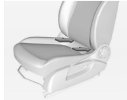
Posizionare il sistema di sicurezza per bambini al centro del sedile e spingere all'indietro. Accertarsi che il sistema di sicurezza per bambini sia innestato adeguatamente.
