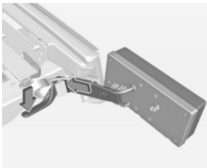
Premere la leva di bloccaggio verso il basso e premere il supporto della lampada nel fermo fino a quando si blocca.
