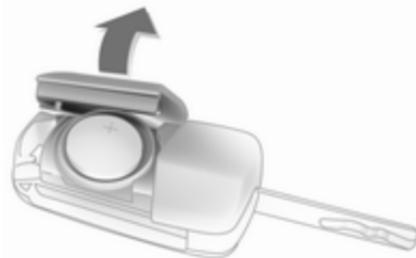
Estendere la chiave e aprire l'unità lateralmente. Sostituire la batteria (di tipo CR 2032) prestando attenzione alla posizione di installazione. Chiudere l'unità e sincronizzarla.
