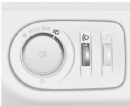
Per regolare la profondità delle luci in base al carico del veicolo e non abbagliare i conducenti dei veicoli in avvicinamento: ruotare la manopola
