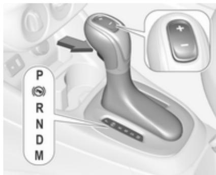
**P** = posizione di parcheggio, le ruote sono bloccate, innestare solo a veicolo fermo e con il freno di stazionamento azionato
