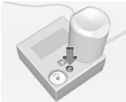
Se la pressione prescritta per il pneumatico non viene raggiunta entro 10 minuti, rimuovere il kit di riparazione dei pneumatici. Spostare il veicolo facendo compiere un giro completo al pneumatico. Ricollegare il kit di riparazione dei pneumatici e continuare la proce-
