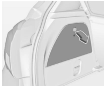
1. Staccare il coperchio nel vano di carico sul lato rispettivo e rimuoverlo.
