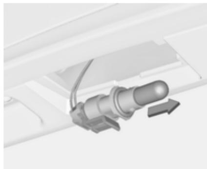
3. Smontare il portalamпада dall'alloggiamento della lampada ruotando in senso antiorario.
