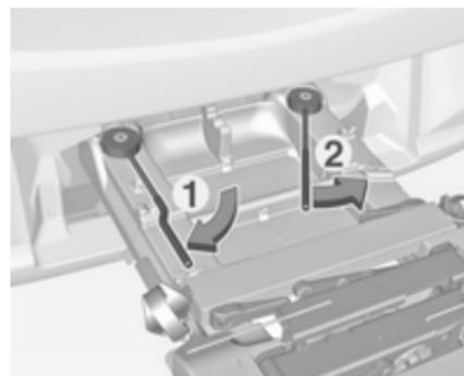
Ruotare prima la leva di bloccaggio sinistra (1), poi agire sulla leva destra (2) fino a quando si fermano. Entrambe le leve di bloccaggio devono essere rivolte all'indietro, in caso contrario non è garantita la sicurezza del funzionamento.
