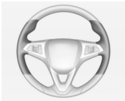
Le zone evidenziate di presa del volante vengono riscaldate più velocemente e a una temperatura maggiore rispetto alle altre zone del volante.
