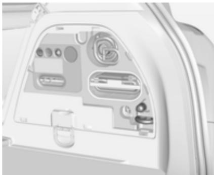
Alcuni attrezzi, il gancio di traino e il kit di riparazione pneumatici sono posizionati nel vano di carico sotto la copertura del pavimento.
