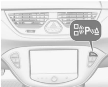
I veicoli con sistema di ausilio al parcheggio anteriore-posteriore e Dispositivo di assistenza al parcheggio avanzato sono riconoscibili dal pulsante **P**▲.
