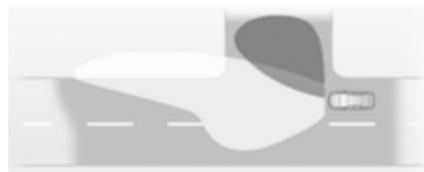
Nelle curve strette o allo spegnimento, a seconda dell'angolo di sterzata o del segnale dell'indicatore di direzione, viene attivato un riflettore supplementare destro o sinistro che illumina la strada nel senso di marcia. Si attiva fino ad una velocità massima di 40 km/h.
