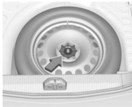
La ruota di scorta è situata nel vano bagagli sotto la copertura del pianale. È fissata mediante un dado ad alette.
