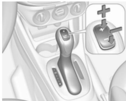
Portare la leva del cambio in posizione **M**.
