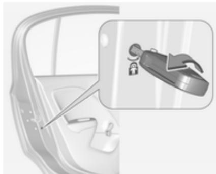
Servendosi di una chiave o di un cacciavite idoneo, ruotare il pulsante nella serratura della portiera poste-
