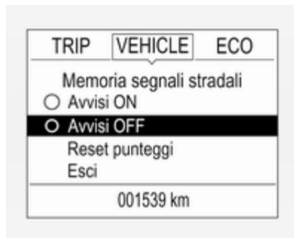
Una volta visualizzata la pagina d'impostazione, selezionare **Avvisi ON** per disattivare l'allarme pop-up. Disattivare selezionando **Avvisi OFF**. Quando si inserisce l'accensione, viene disattivata la funzione di allarme.
