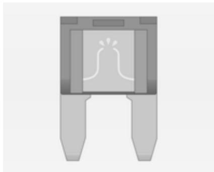
A seconda del tipo di fusibile, un fusibile bruciato si riconosce dalla fusione del filo metallico all'interno. Sostituire il fusibile solo dopo aver eliminato la causa del guasto.
