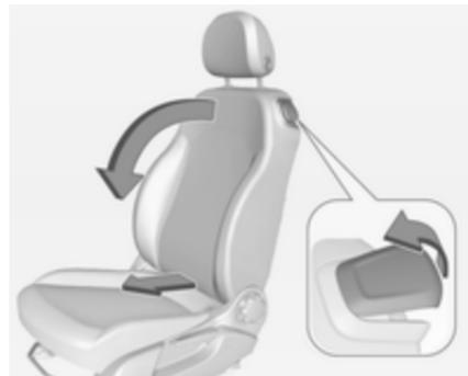
Tirare in avanti la leva di sbloccaggio e ripiegare lo schienale in avanti. Quindi far scorrere il sedile in avanti fino a battuta.
