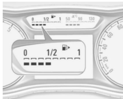
Il numero di LED segnala il livello del carburante nel serbatoio.
