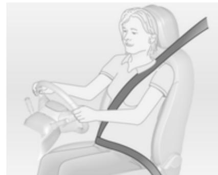
Le cinture di sicurezza sono bloccate durante le accelerazioni e decelerazioni brusche del veicolo, per mantenere gli occupanti dell'auto in posizione corretta. Pertanto il rischio di lesioni si riduce notevolmente.
