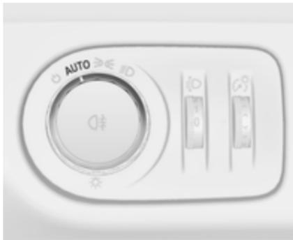
Quando la funzione di comando automatico dei fari è attivata e il motore è in funzione, il sistema passa dalle luci diurne all'accensione dei fari automaticamente, a seconda delle condizioni della luminosità e delle informazioni fornite dal sistema del sensore pioggia.
