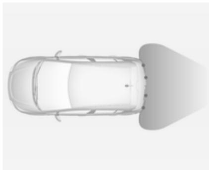
Il sistema è dotato di quattro sensori di parcheggio ad ultrasuoni ubicati nel paraurti posteriore.
