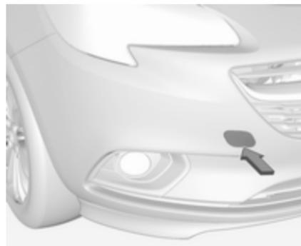
Inserire un cacciavite nella fessura sulla parte inferiore del cappello. Sganciare il coperchio muovendo con cautela il cacciavite verso il basso. L'occhiello di traino è riposto insieme agli attrezzi per il veicolo ⇨ 210.
