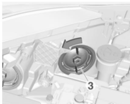
1. Ruotare il coperchio (3) in senso antiorario e rimuoverlo.
