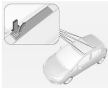
Sbloccare verso il basso le coperture che nascondono i fissaggi del portapacchi premendo i corsoi nella direzione della freccia e smontarle agendo verso l'alto. Per chiudere i fissaggi del portapacchi, inserire prima le coperture anteriormente e bloccare i corsoi posteriormente.
