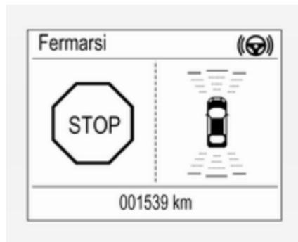
Se il conducente non ferma il veicolo entro 10 metri per spazi di parcheggio paralleli o sei metri per spazi di parcheggio perpendicolari dopo il suggerimento di uno spazio, il sistema cerca un altro spazio di parcheggio adeguato.
