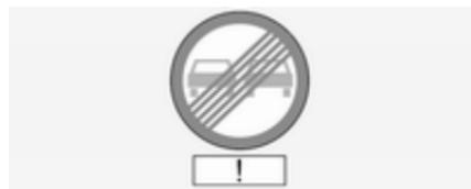
Un punto esclamativo in un riquadro indica che è stato rilevato un altro segnale che il sistema non è in grado di riconoscere.
