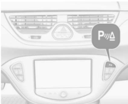
Veicoli con sistema di ausilio al parcheggio posteriore o anteriore-posteriore sono dotati del pulsante **P**▲.
