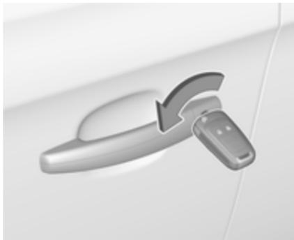
Sbloccare manualmente la portiera del conducente girando la chiave nella serratura. Inserire l'accensione e premere il pulsante di chiusura cen-
