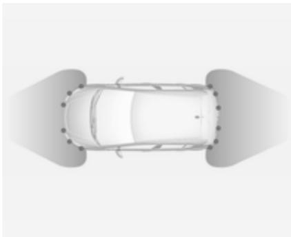
Il dispositivo di assistenza al parcheggio avanzato è sempre abbinato al sistema di ausilio al parcheggio anteriore-posteriore, vedere sezione precedente. I due sistemi condividono gli stessi sensori ubicati sul paraurti anteriore e posteriore.
