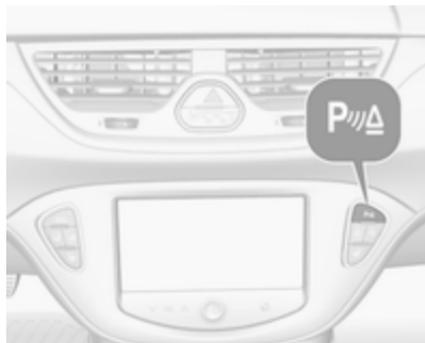
Il sistema si disattiva automaticamente disinserendo la retromarcia. È inoltre possibile disattivare manualmente il sistema premendo il pulsante del sistema di ausilio al parcheggio **P**⚠.
