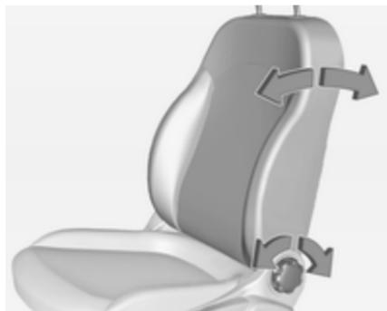
Ruotare la manopola per regolare l'inclinazione. Non appoggiarsi allo schienale durante la regolazione.
