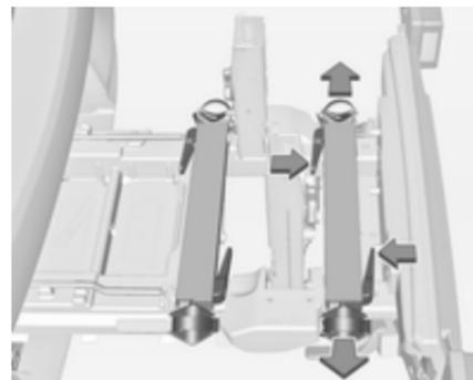
Premere la leva di sblocco ed estrarre l'alloggiamento delle ruote.
