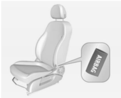
Il sistema airbag laterale è composto da un airbag nello schienale di ciascun sedile anteriore. La posizione è segnalata dalla scritta **AIRBAG**.
