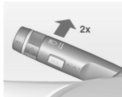
L'assistente all'uso degli abbaglianti viene attivato spingendo due volte la leva degli indicatori di direzione a una velocità superiore a 40 km/h.
