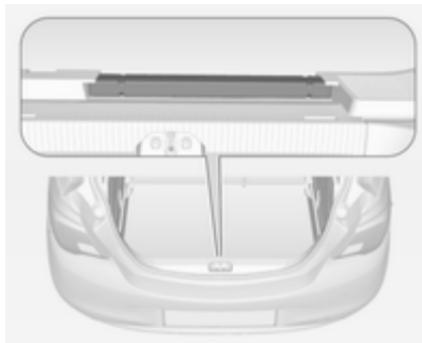
Il triangolo di emergenza viene riposto nel vano di carico sotto il portellone posteriore.
