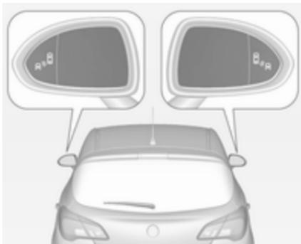
L'allarme angolo morto laterale è attivo a velocità comprese tra 10 km/h e 140 km/h. Velocità superiori ai 140 km/h disattivano il sistema, come segnalato dal simbolo luminoso  $\text{a}^{\text{b}}$  su entrambi gli specchietti esterni. Riducendo di nuovo la velocità i simboli luminosi si spegneranno. Se un veicolo viene quindi rilevato nella zona di angolo morto, i simboli di avvertimento  $\text{a}^{\text{b}}$  si illumineranno come consueto sul lato interessato.
