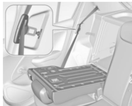
Se il veicolo viene caricato posteriormente, estrarre la cinghia di sicurezza dalla guida dello schienale del sedile e inserire la piastra di chiusura nell'alloggiamento come mostrato in figura.
