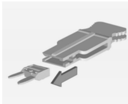
Posizionare l'estrattore per fusibili sulla sommità del fusibile, a seconda del tipo, ed estrarre il fusibile.
