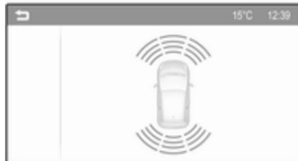
La distanza con ostacoli viene visualizzata nel Visualizzatore a colori Info mediante zone colorate di fronte o dietro al veicolo ⇨ 103.
