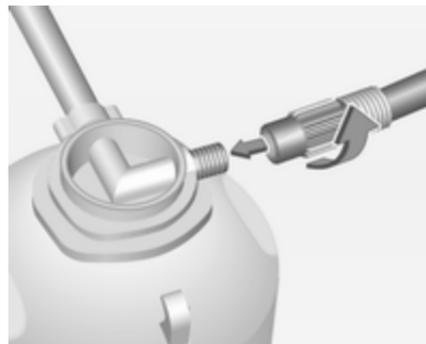
2. Staccare il tubo dell'aria dalla staffa e avvitarlo al raccordo della bombola.
