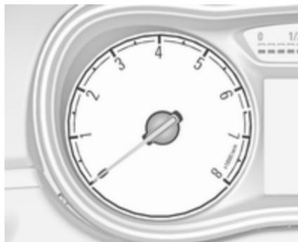
Indica la velocità di rotazione del motore.
