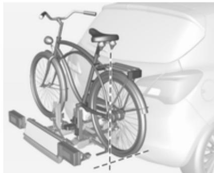
Allineare la bicicletta nella direzione longitudinale del veicolo. Allentare leggermente il fissaggio del pedale. Mettere la bicicletta in posizione dritta usando la leva girevole della cavità della pedivella.
