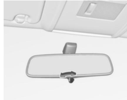
Per ridurre l'abbagliamento, agire sulla leva nella parte inferiore del corpo dello specchietto.
