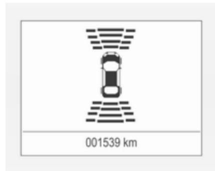
La distanza con un ostacolo che precede o segue viene visualizzata mediante linee di distanza variabili nel Driver Information Centre.
