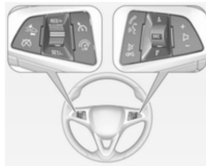
Controllo automatico della velocità di crociera, Limitatore di velocità, Sistema Infotainment e un cellulare collegato possono essere azionati mediante i comandi al volante.
