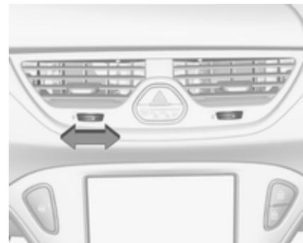
Ruotare la rotella per regolare il flusso di aria in uscita dalla bocchetta. La bocchetta viene chiusa ruotando la rotella di regolazione a fine corsa a destra o a sinistra.
