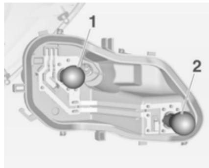
5. Smontare e sostituire la lampadina spingendola leggermente nel portalamпада e ruotandola in senso antiorario:
