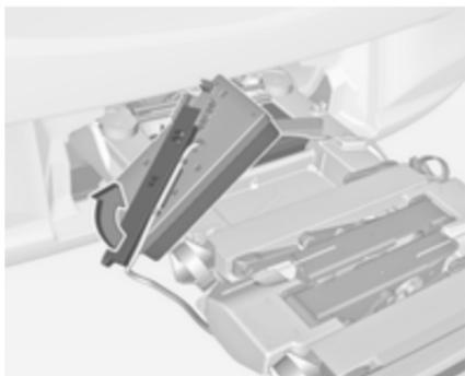
Aprire il supporto della lampada sulla parte posteriore delle luci posteriori fino a quando si blocca in posizione.
