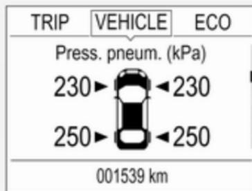
6. Premere il pulsante **SET/CLR** per iniziare il processo di abbinamento del sensore. Viene visualizzato un messaggio che richiede l'accettazione del processo.
