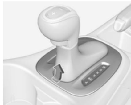
2. Staccare il rivestimento della leva del cambio dalla consolle centrale; inserire un dito nell'interstizio in pelle di fronte alla leva del cambio e spingere il rivestimento verso l'alto sul bordo anteriore da sotto, come illustrato. Ruotare il bordo a sinistra.
