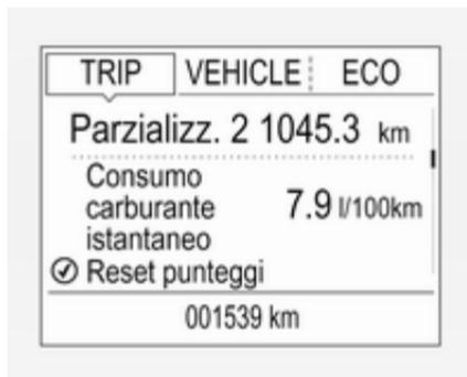
Le pagine del menu del visualizzatore Deluxe si selezionano premendo il tasto **MENU** sulla leva dell'indicatore di direzione. I simboli del menu principale vengono indicati nella riga superiore del display:
