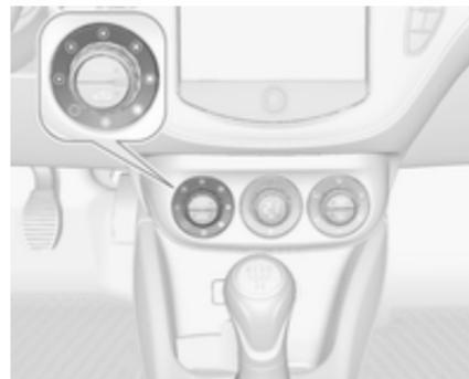
Ruotare la manopola sinistra per aumentare o diminuire la velocità della ventola. La velocità della ventola viene indicata sul Visualizzatore Info.
