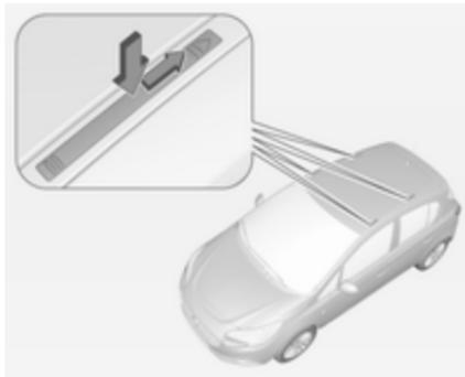
Spingere verso il basso le coperture che nascondono i fissaggi del portapacchi e premere all'indietro con una chiave per il cappuccio delle valvole  $\varnothing$  210.
