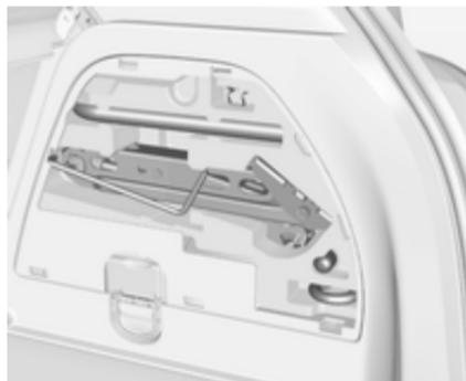
Il martinetto, la chiave per bulloni ruota ed alcuni attrezzi sono posizionati sul lato destro del vano di carico dietro ad un coperchio ↗ 73.
