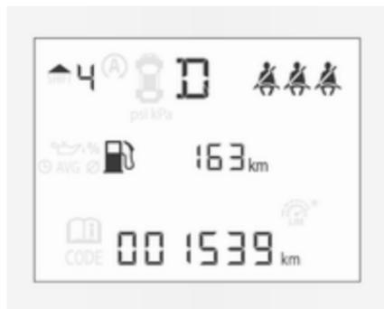
Le pagine del menu del visualizzatore standard si selezionano premendo il tasto **MENU** sulla leva dell'indicatore di direzione.
