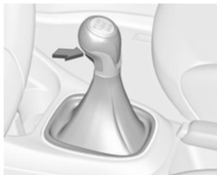
Per inserire la retromarcia, premere il pedale della frizione e poi il pulsante sulla leva del cambio e inserire la marcia.
