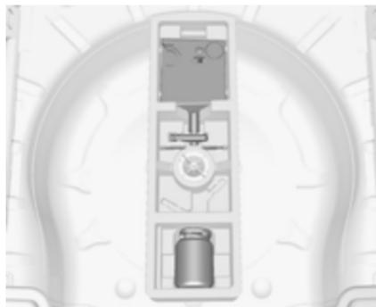
Alcuni attrezzi e l'occhiello di traino sono riposti assieme al kit di riparazione dei pneumatici in una cassetta porta attrezzi ubicata nel vano di carico sotto la copertura del pavimento.
