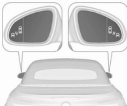
L'allarme angolo morto laterale è attivo a velocità comprese tra 10 km/h e 140 km/h. Velocità superiori ai
