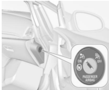
Gli airbag del passeggero anteriore possono essere disattivati tramite un interruttore a chiave nel lato destro del quadro strumenti.
