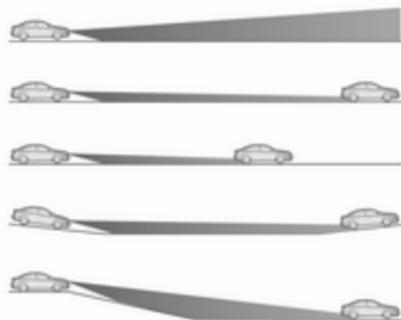
Una speciale funzione di valutazione topografica rileva i veicoli che precedono lungo pendii rilevando il movimento delle luci posteriori davanti. Il sistema regola l'altezza della portata luminosa per garantire l'illuminazione ottimale della superficie stradale antistante senza abbagliare.
