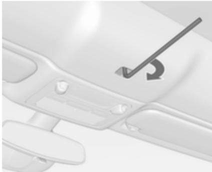
15. Inserire la chiave Allen da 6 mm nella chiusura e bloccare la chiusura ruotando la chiave Allen in senso orario fino alla sua posizione finale.
