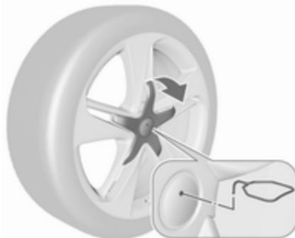
Ruote in lega con copribullone ruota centrale: Disinnestare il co-
