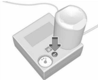
Se la pressione prescritta per il pneumatico non viene raggiunta entro 10 minuti, rimuovere il kit di riparazione dei pneumatici. Spostare il veicolo facendo compiere un giro al pneumatico. Ricollegare il kit di riparazione dei pneumatici e continuare la procedura di gon-
