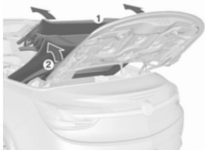
12. Estrarre il tettuccio morbido sollevando l'arco anteriore (1) e contemporaneamente l'arco di tensionamento (2) su entrambi i lati.
