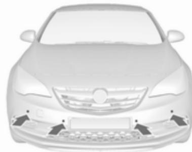
Il sistema è dotato di quattro sensori di parcheggio ad ultrasuoni ubicati nei paraurti posteriore e anteriore.
