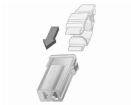
Posizionare l'estrattore per fusibili sulla sommità o sul lato del fusibile, a seconda del tipo, ed estrarre il fusibile.
