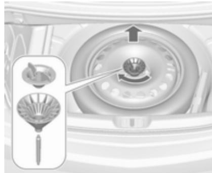
5. Inserire e ruotare il cono eccentrico nella cavità della ruota di scorta in modo che la ruota sia posizionata per quanto possibile verso la parte anteriore. Fissare la ruota ruotando il galletto in senso orario.
