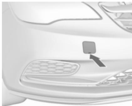
Inserire un cacciavite nella fessura sulla parte inferiore del cappello. Sganciare il coperchio muovendo con cautela il cacciavite verso il basso. L'occhiello di traino è riposto insieme agli attrezzi per il veicolo ⇨ 221.
