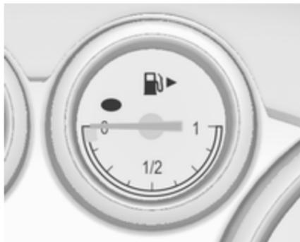
Visualizza il livello del carburante nel serbatoio.
