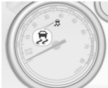
Il sistema ESC è operativo dopo ogni avviamento del motore, allo spegnimento della spia
