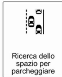
Se il veicolo passa accanto a una fila di veicoli con il sistema attivato, il dispositivo di assistenza al parcheggio avanzato inizia a cercare uno spazio di parcheggio adeguato. Al rilevamento di uno spazio adeguato, il sistema emette una segnalazione visiva nel Driver Information Center e una acustica.
