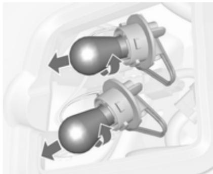
4. Rimuovere e sostituire la lampadina.
