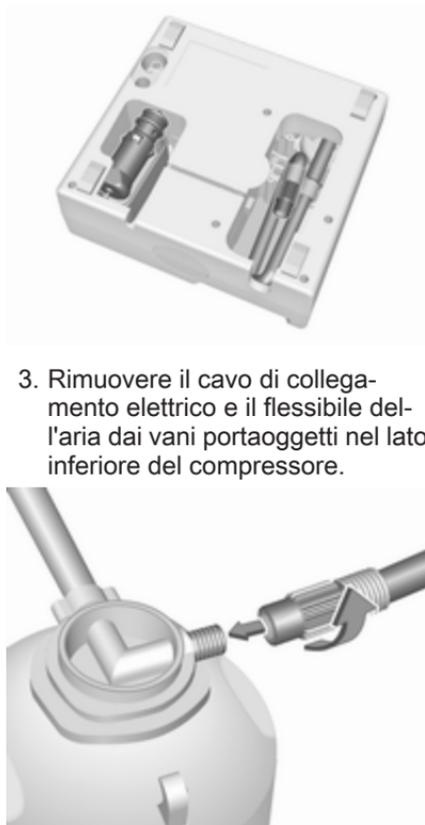
3. Rimuovere il cavo di collegamento elettrico e il flessibile dell'aria dai vani portaoggetti nel lato inferiore del compressore.
