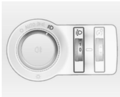
Per regolare la profondità delle luci in base al carico del veicolo e non abbagliare i conducenti dei veicoli in avvicinamento: ruotare l'interruttore rotante
