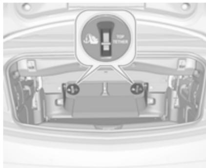
Oltre al supporto ISOFIX, fissare la fascia Top-Tether agli occhielli di fissaggio Top-Tether sul retro dei sedili posteriori. Ripiegamento degli schienali posteriori ⇨ 75.
