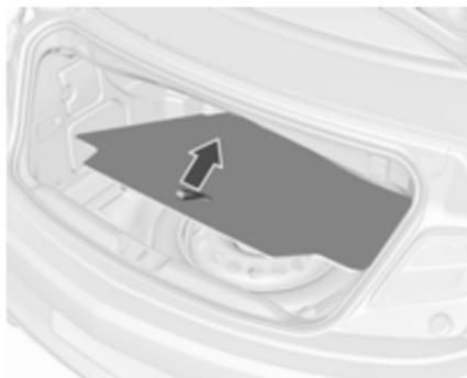
È possibile sollevare e rimuovere la copertura del pavimento posteriore. Sotto la copertura c'è la ruota di scorta, gli attrezzi per il veicolo o il kit di riparazione dei pneumatici.
