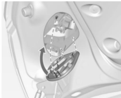
5. Chiudere il coperchio inserendo prima le graffe di fissaggio. Bloccare il coperchio ruotando la vite in senso orario con una moneta.
