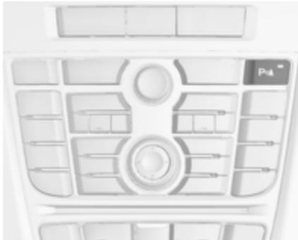
Il sistema di ausilio al parcheggio anteriore-posteriore è dotato di **P<sub>▲</sub>**. Se il veicolo è anche dotato di dispositivo di assistenza al parcheggio avanzato (consultare la seguente descrizione a
