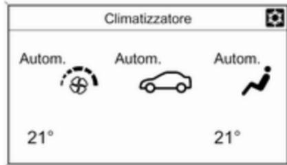
Le impostazioni del climatizzatore sono visualizzate sul Visualizzatore grafico Info o, a seconda della versione, sul Visualizzatore a colori Info. Le modifiche alle impostazioni vengono brevemente visualizzate da entrambi i visualizzatori si sovrappongono al menu visualizzato in quel momento.
