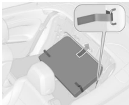
Ripiegare in basso gli schienali posteriori. Allineare la copertura rigida dell'astuccio al vano di carico. Posizionare l'astuccio con la parte bassa rivolta verso l'alto nella guida laterale all'interno della cavità del telaio superiore. Fissare l'astuccio con la fa-
