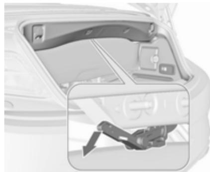
3. All'interno del bordo del vano di carico superiore si trova una leva per sbloccare lo sportello del tettuccio morbido. Individuare la leva e aprire ruotando la leva verso il basso.
