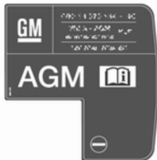
È possibile identificare una batteria AGM dall'etichetta presente sulla batteria. Si raccomanda l'uso di una batteria veicolo originale Opel.
