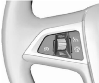
Premere . Se il controllo automatico della velocità di crociera è stato attivato prima, questo viene disinserito all'attivazione del limitatore di velocità e la spia si spegne.
