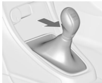
Per innestare la retromarcia, con il veicolo fermo e premendo il pedale della frizione, premere il pulsante di sblocco sulla leva del cambio e innestare la marcia.
