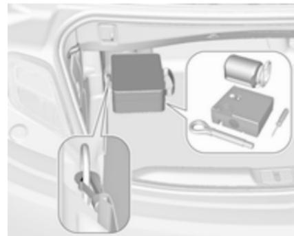
Alcuni attrezzi e il gancio di traino si trovano insieme al kit di riparazione dei pneumatici in un sacchetto, fissato all'occhiello di ancoraggio anteriore sinistro nel vano di carico.
