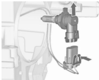
3. Sganciare il portalampada del connettore premendo sulla linguetta di fissaggio.
