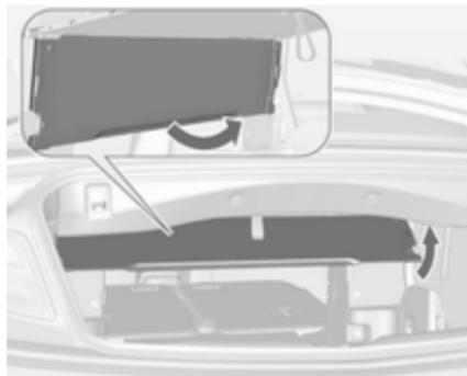
Per trasportare oggetti lunghi nel vano di carico si può aprire un'aletta passante tra il vano di carico e l'interno del veicolo:
