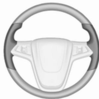
Le zone evidenziate di presa del volante vengono riscaldate più velocemente e a una temperatura maggiore rispetto alle altre zone del volante.
