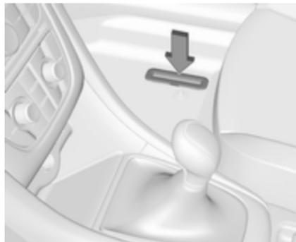
Il numero di telaio (VIN) potrebbe essere stampigliato sulla targhetta di identificazione della vettura e sul sottoscocca, sotto la copertura del pianale, ed è visibile attraverso una proiezione.
