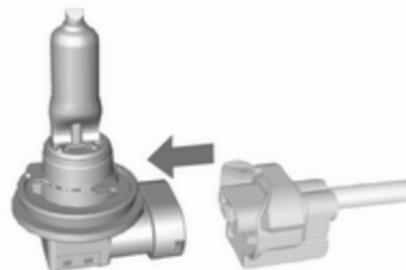
2. Sganciare il portalampada dal connettore premendo sulla linguetta di fissaggio.
