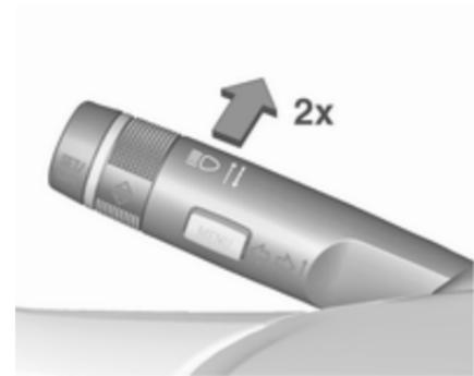
L'assistente all'uso degli abbaglianti viene attivato spingendo due volte la leva degli indicatori di direzione a una velocità superiore a 40 km/h.
