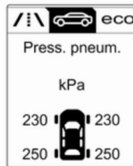
Ruotare la manopola di regolazione per selezionare il sistema di monitoraggio pressione pneumatici.
