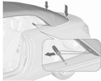
18. Spingere in basso con forza su ogni lato dell'arco di tensionamento. Contemporaneamente tirare il laccio con un cacciavite lentamente attraverso l'anello continuando verso la parte anteriore. Se possibile appoggiarsi al telaio della portiera con l'altra mano. Eseguire questa operazione su entrambi i lati per chiudere il tettuccio morbido sul retro.
