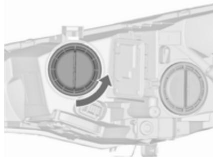
1. Ruotare il coperchio in senso antiorario e rimuoverlo.
