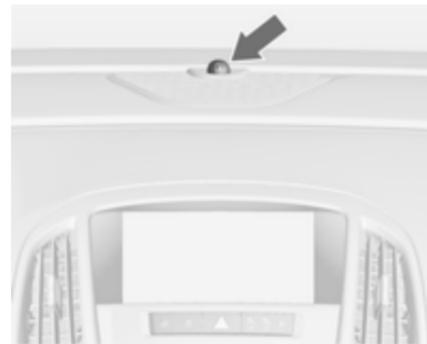
Il LED di stato è integrato nel sensore nella parte superiore del quadro strumenti.
