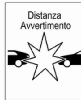
Quando la distanza con un veicolo in movimento antistante diventa troppo breve o quando ci si avvicina ad un altro veicolo troppo rapidamente e una collisione è imminente, il simbolo di allarme collisione appare nel Driver Information Center.
