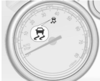
Il sistema TC è operativo dopo ogni avviamento del motore, allo spegnimento della spia
