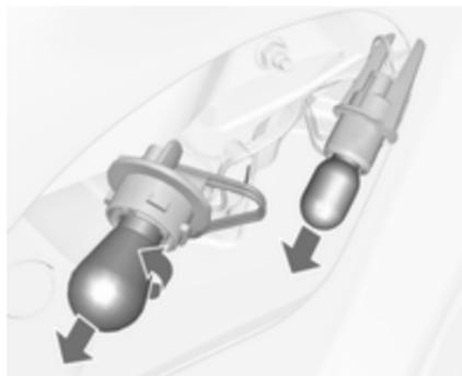
3. Rimuovere e sostituire la lampadina
