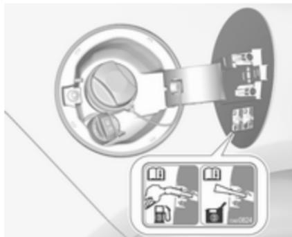
L'inibitore di mancate accensioni garantisce che il portellino del bocchettone di rifornimento del carburante possa essere aperto solo usando un ugello per carburante diesel o un imbuto per rifornimenti di emergenza.
