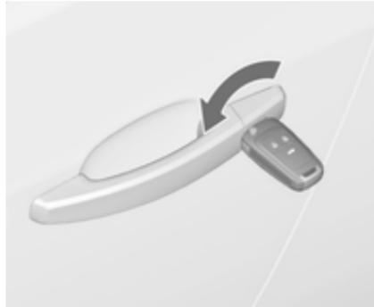
Sbloccare manualmente la portiera del conducente ruotando la chiave nella serratura. Inserire l'accensione e premere il pulsante di chiusura centralizzata
