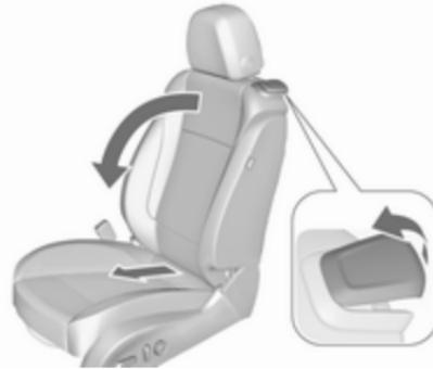
Sollevare la leva di sblocco e piegare lo schienale in avanti. Il sedile scorre automaticamente in avanti fino in battuta.
