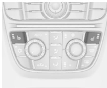
Regolare il riscaldamento sul livello desiderato premendo
