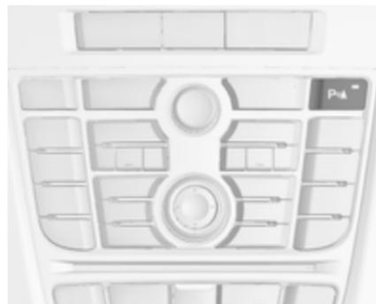
È possibile disattivare manualmente il sistema premendo brevemente il pulsante del sistema di ausilio al parcheggio **P▲** o **⏏P▲**.
