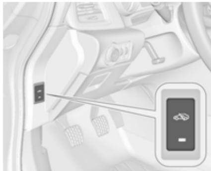
Disattivare la funzione di controllo dell'abitacolo e dell'inclinazione del veicolo se persone o animali sono all'interno del veicolo a causa dei forti segnali a ultrasuoni e della possibile attivazione dell'allarme provocata dai movimenti. Disattivare anche se il veicolo viene trasportato su un traghetto o su un treno.
