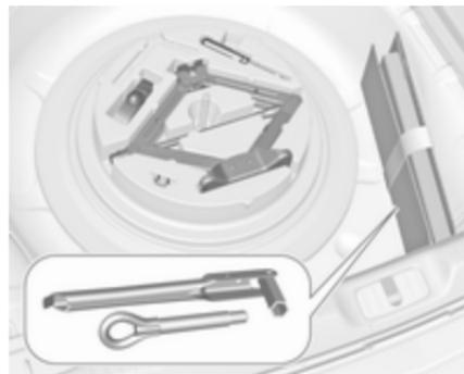
Aprire la copertura del pianale di carico. Il martinetto, gli attrezzi e una cinghia per fissare una ruota danneggiata si trovano nella cassetta porta attrezzi sotto la ruota di scorta nel vano di carico. La chiave per ruote e l'occhiello di traino sono nella borsa porta attrezzi nel pozzetto della ruota di scorta, vicino alla cassetta porta attrezzi. Ruota di scorta ⇨ 235.
