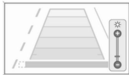
**Navi 650/Navi 950:** è possibile impostare la luminosità dapprima premendo e poi ruotando la ghiera esterna della manopola multifunzione.
