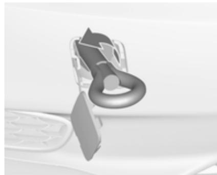
Avvitare a fondo l'occhiello di traino in senso antiorario fino all'arresto in posizione orizzontale.
