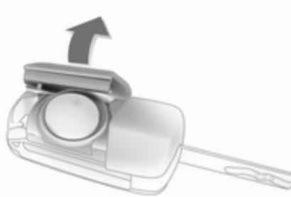
Estendere la chiave e aprire l'unità lateralmente. Sostituire la batteria (di tipo CR 2032) prestando attenzione alla posizione di installazione. Chiudere l'unità e sincronizzarla.
