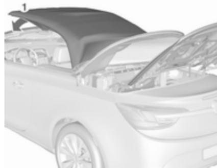
13. Spostare l'arco anteriore (1) sul telaio del parabrezza.
