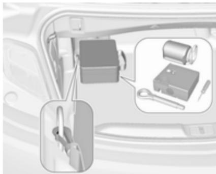
Su un'altra versione, un sacchetto contenente il kit di riparazione dei pneumatici è fissato all'occhiello di ancoraggio posteriore sinistro nel vano di carico.
