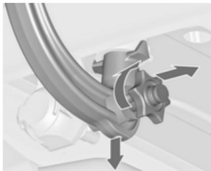
Aprire il coperchietto di protezione e ruotare la chiave in posizione
