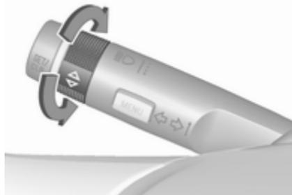
Ruotare la manopola di regolazione per selezionare un'opzione di menu o per impostare un valore numerico.
