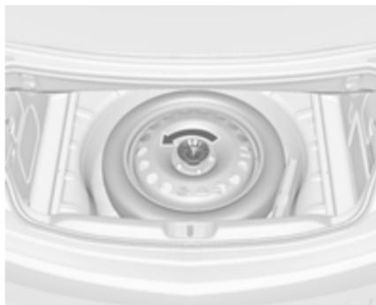
3. La ruota di scorta è fissata nel pozzetto con un galletto. Svitare il
