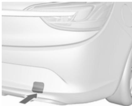
Inserire un cacciavite nella fessura sulla curvatura inferiore del cappello. Sganciare il coperchio muovendo con cautela il cacciavite verso il basso.
