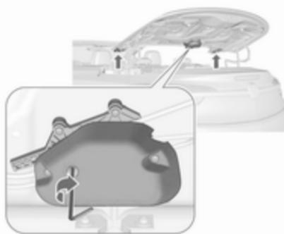
6. Inserire la chiave Allen da 4 mm nella posizione contrassegnata dell'unità di azionamento dell'aletta. Ruotare la chiave Allen in senso orario completamente fino all'arresto così che le alette lateralmente ruotino all'interno.
