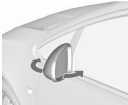
Per la sicurezza dei pedoni, gli specchietti retrovisori esterni fuoriescono dalla normale posizione di montaggio se vengono colpiti con forza sufficiente. Per riposizionare lo specchietto è sufficiente esercitare una leggera pressione sul corpo dello stesso.
