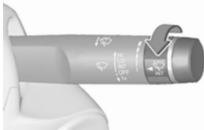
Ruotare la manopola di regolazione per regolare la sensibilità del tergicristalli:
